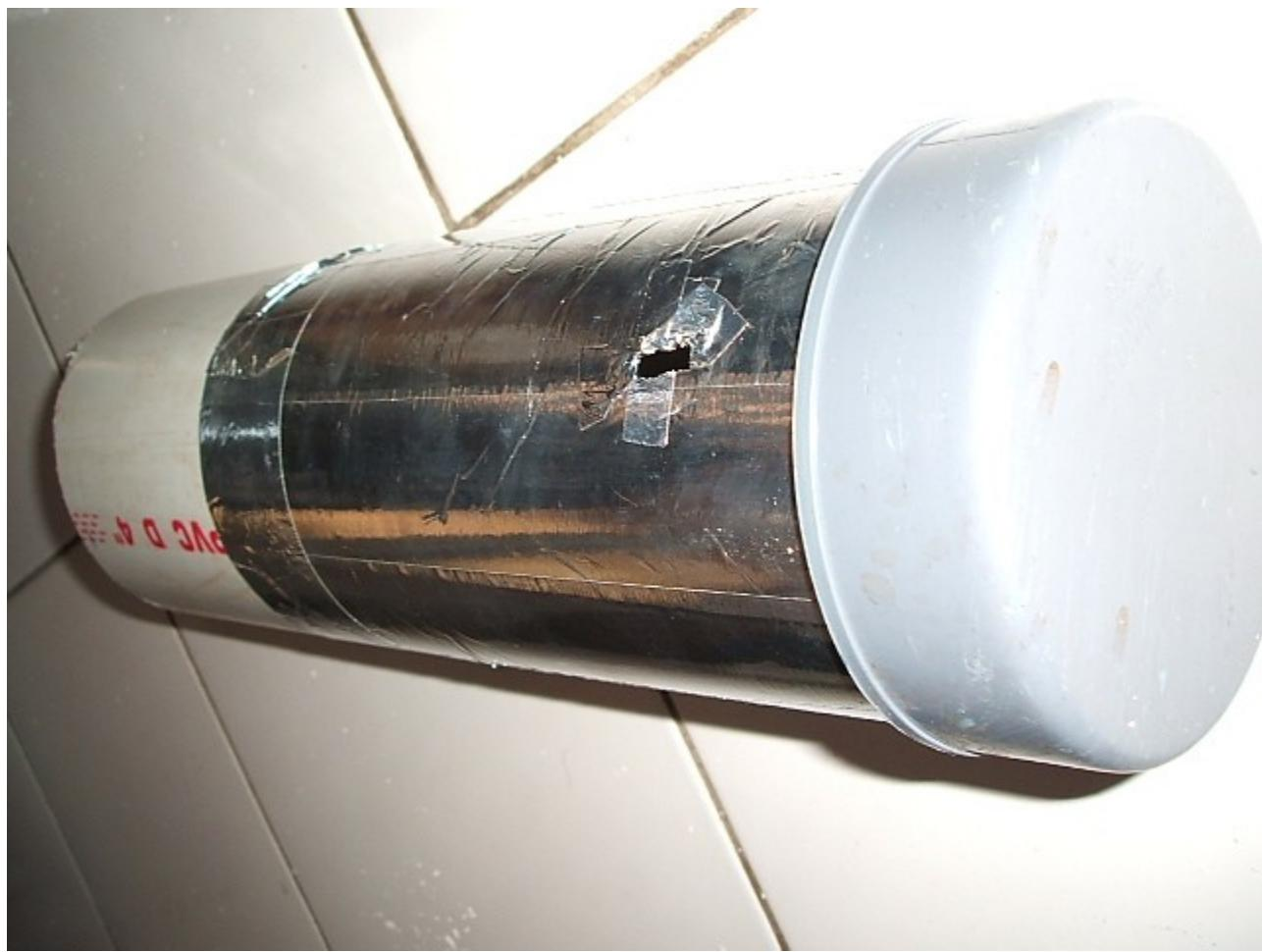
Langkah 3. Beri lakban aluminium pada badan pipa pralon sampai 25 cm dari ujung. Lubangi menggunakan cutter lokasi tempat masuknya USB modem pada jarak 6.8cm dari ujung. Tutupkan dop pralon 4" yang kita beri lakban pada pipa pralon.
