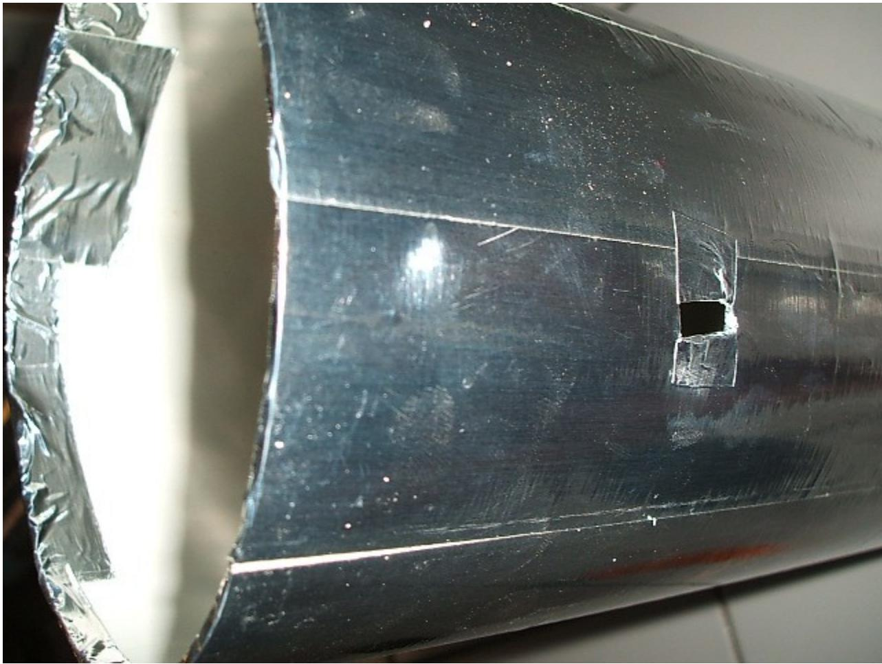
Langkah 2. Lubangi lakban aluminium pada posisi 6.8cm tempat USB modem 3G akan di masukan. Lapisi pinggiran lubang USB modem 3G dengan lakban aluminium agar nantinya ground USB modem 3G akan bersentuhan dengan lakban aluminium.
