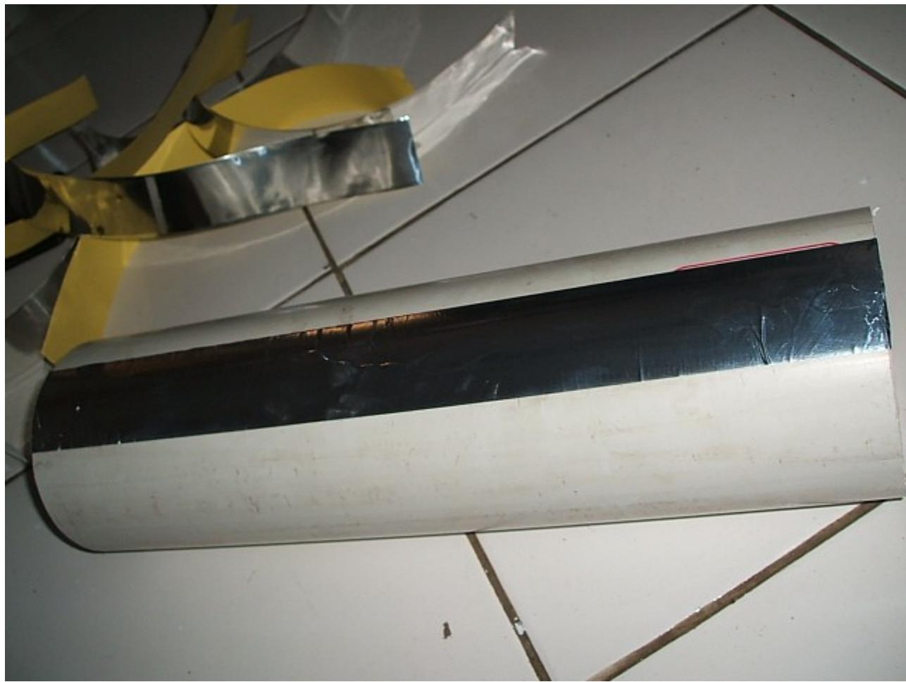
Langkah 1. Potong pipa pralon 4" sepanjang 40 cm. Lubangi pipa pralon pada posisi 6.8cm untuk memasukan USB modem 3G. Gunakan cutter pada lubang USB untuk memastikan bahwa modem USB 3G dapat kita masukan ke lubang USB di pipa pralon. Lapisi seluruh permukaan pipa pralon menggunakan lakban aluminium.
