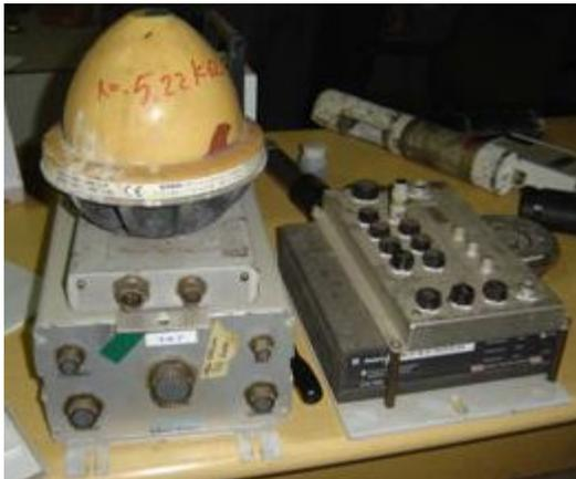
Sistem komunikasi data yang digunakan dalam sistem seawatch Indonesia berupa perangkat transmitter dan receiver satelit ARGOS dan INMARSAT. Tampak digambar Central Processing Unit yang mengelola sistem kerja peralatan dinamakan GENI sistem.
