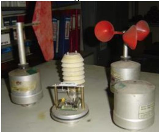
Sensor meteorologi pada seawatch Indonesia terdiri :
