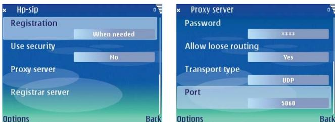
Masukkan username dan password sesuai ip dan password yang terdaftar pada SIP server. Pilih Allow Loose routing "Yes" dengan catatan tidak ada routing yang dilakukan. Pilih transport "UDP" dan Port "5060" sebagai standard dari SIP server. Lakukan untuk Registrar server, dengan mengisi data yang sama. Pilih back untuk keluar, maka akan otomatis setting untuk SIP sudah terkonfigur. Kemudian pilih "Back" untuk keluar, dan pilih "Internet tel. Settings"
