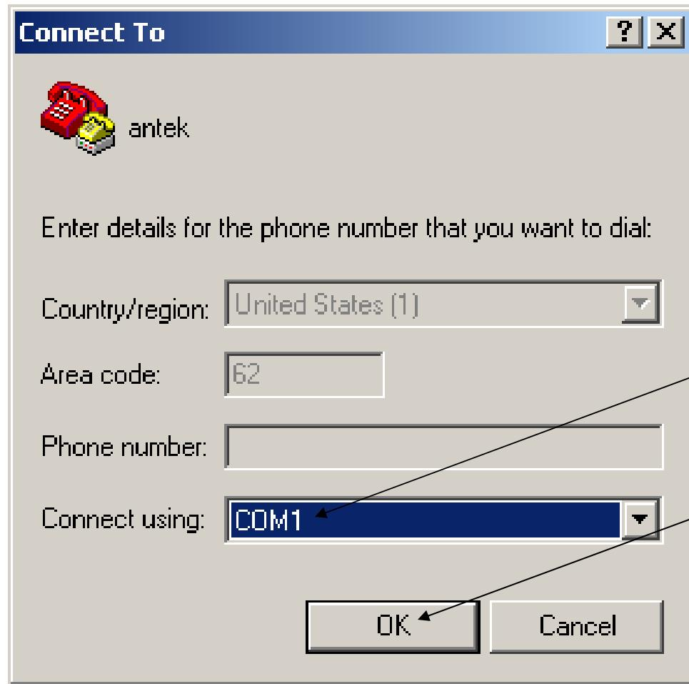
Karena Antek VSP-5002 terhubung melalui port COM1 pada komputer Anda, maka pilih Connect using dengan **COM1**.
