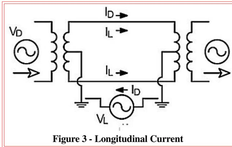
**Figure 3 - Longitudinal Current**
