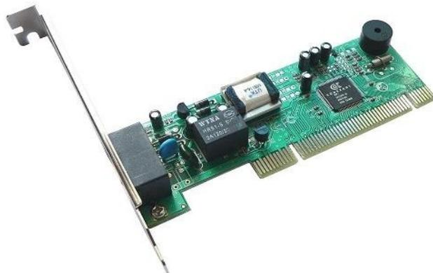
Gambar 2.3 Modem telepon untuk Internet (Sumber: <http://www.alibaba.com>)
