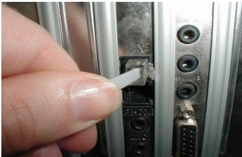
Gambar 2.4 Memasukan kabel telepon ke modem internal
